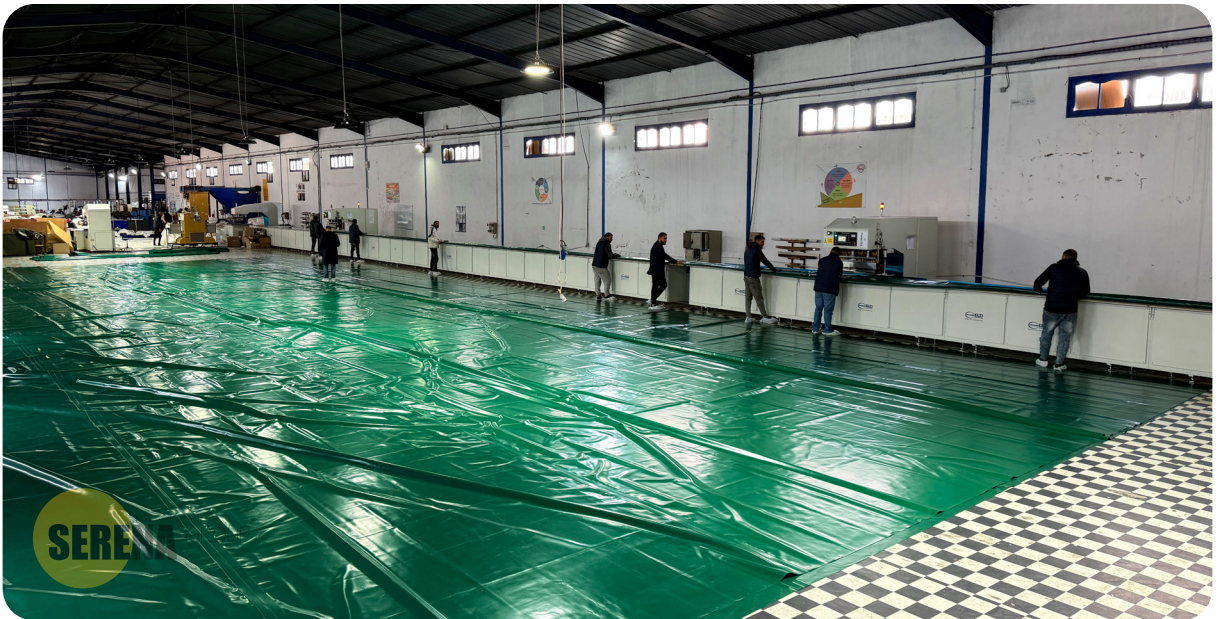
Fabrication d'une citerne de 1000 m 3
