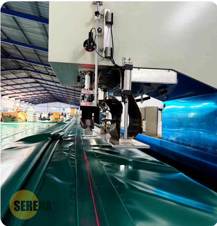
Machine de soudure Haute Fréquence sur table de 30 mètres de long
